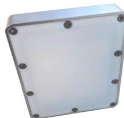
Рисунок Б.5 – Доплеровский радарный бесконтактный датчик скорости
