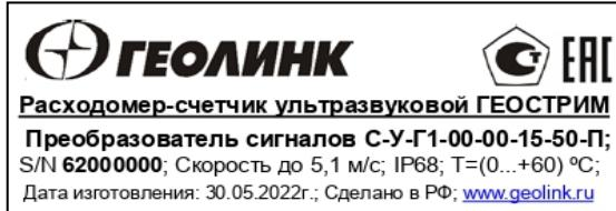
Рисунок 10.1 – Пример идентификационных наклеек на корпусе ЭБ и ПС
