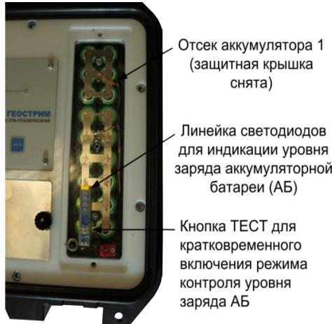
Рисунок Б.13 – Вид отсека основного аккумулятора
