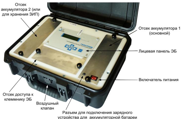
Рисунок Б.12 – Вид элементов расходомера при размещении в кейсе
